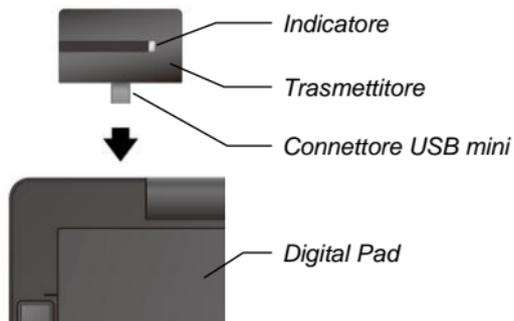
2. Tenere premuto il tasto d'**alimentazione** del Digital Pad (per circa 5 secondi) finché l'indicatore del Trasmettitore lampeggia rapidamente.
